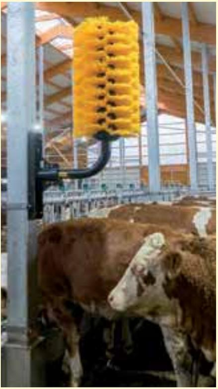
Leichte Stallreinigung durch aufrechtes Fixieren der Bürste mit Heberiegel.
