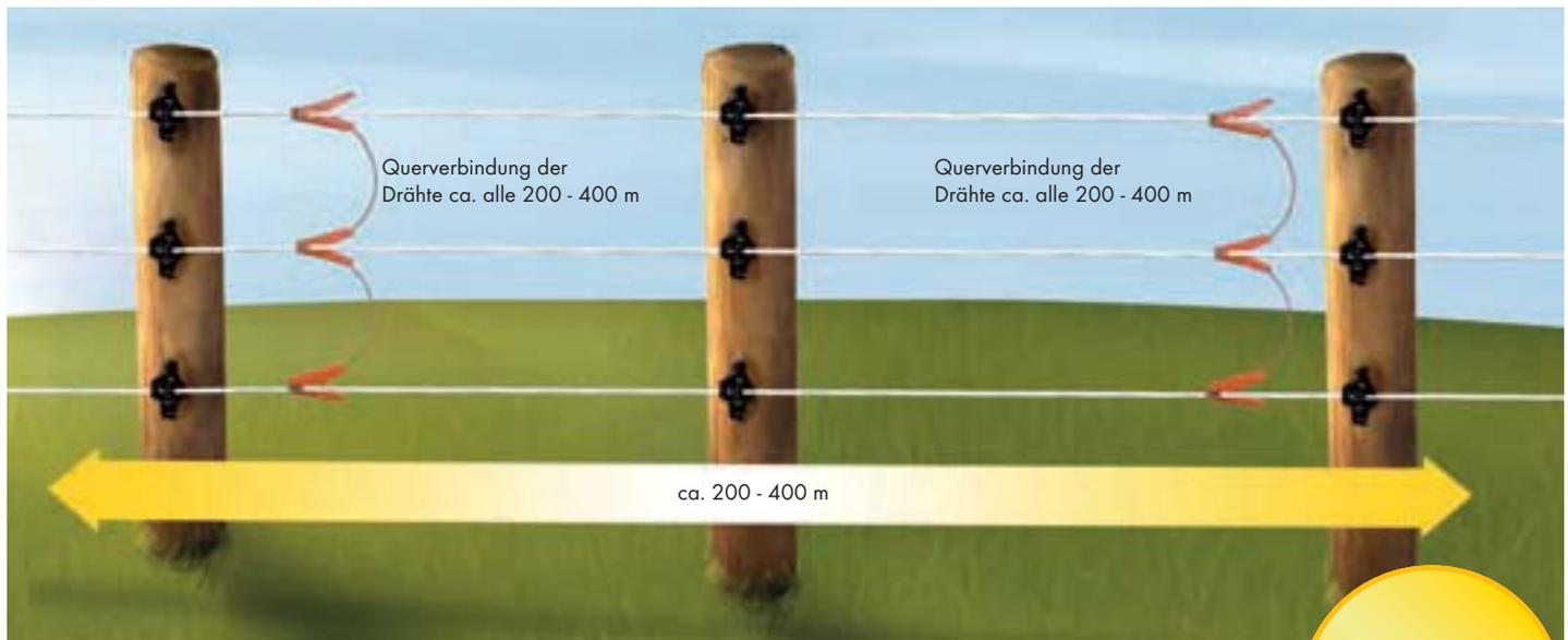
Bei Elektrozäunen sollten alle Drähte in regelmäßigen Abständen von ca. 200 - 400 m quer untereinander verbunden werden. Ideale Stellen für diese Verbindungen sind am Zaunanfang, am Zaumende und an Ecken.
