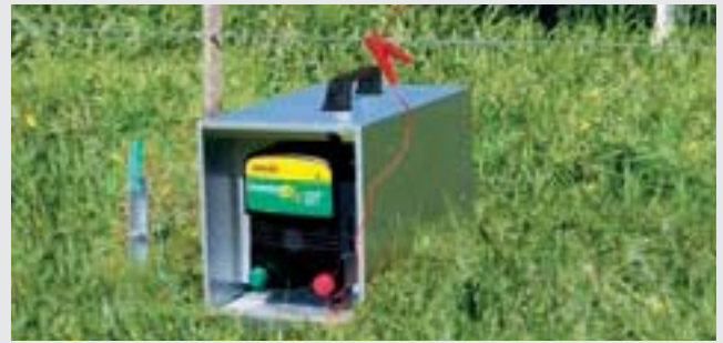
Montage in der Tragebox: Gerät und Batterie stehen geschützt in einer Tragebox unmittelbar in Zaunnähe
