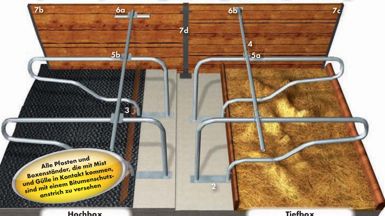
Alle Pfosten und Boxenständer, die mit Mist und Gülle in Kontakt kommen, sind mit einem Bitumenschutzanstrich zu versehen
