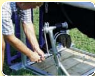
Komfortable Vorderfußwinde zum leichten Anheben der Vorderfüße
